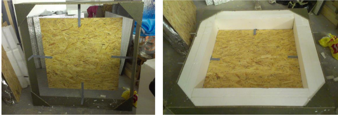
Obr. 7 Ukázka z realizace typického zkušebního prvku pro měření tepelného odporu izolované vzduchové dutiny [autor]
