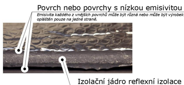
Obr. 1 Schéma složení reflexní izolace [autor, dle ČSN EN 16012]
