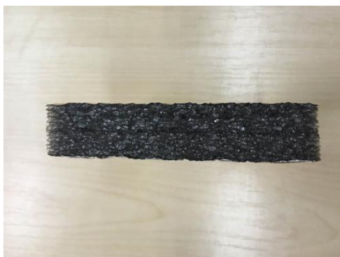
Obr. 2 Typický příklad reflexní izolace typu 1, jádro z pěnového polyetylénu [autor]
