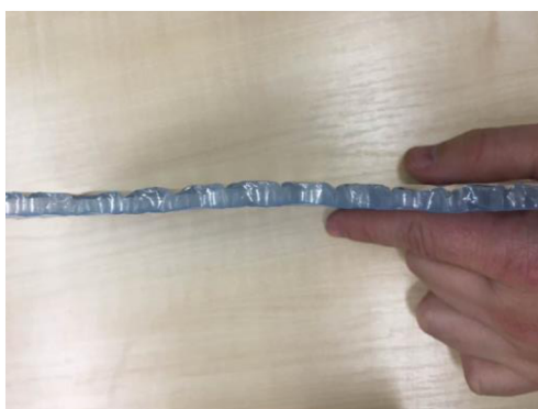
Obr. 4 Typický příklad reflexní izolace typu 1, bublinková folie [autor]
