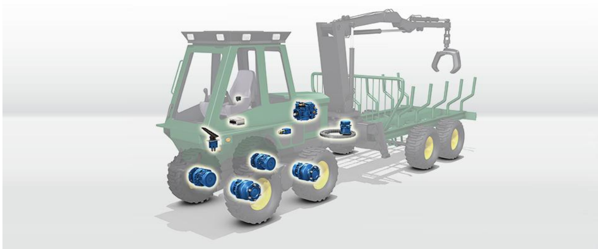
Obr. 13 Lesní vyvážka s hydromotory umístěnými v kolech [9]
