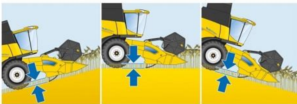
Obr. 8. Udržování stálé výšky strniště hmatači [ŠTURSA 2014]
