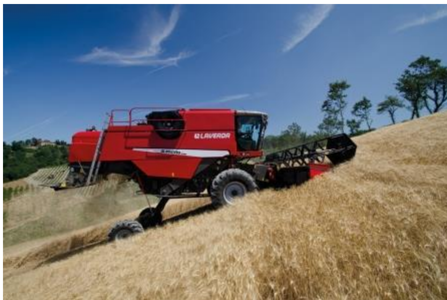
Obr. 21. Podélné vyrovnávání sklízecí mlátičky při jízdě do svahu [LAVERDA S.P.A.]
