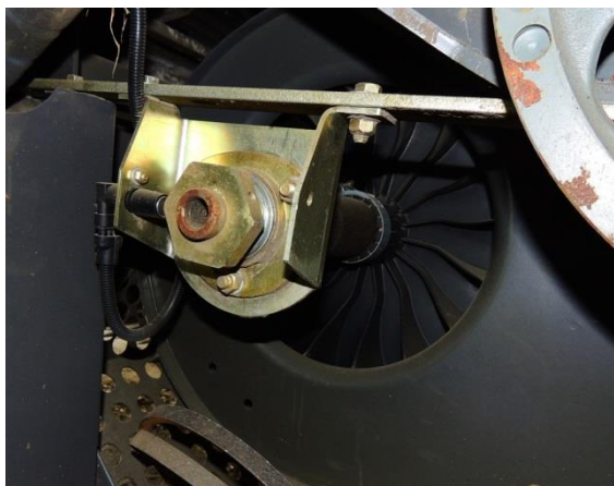
Obr. 16. Snímač otáček ventilátoru [FOTO autor] Obr. 17. Elektromotor nastavení otáček ventilátoru [CLAAS KGAA MBH 2011]
