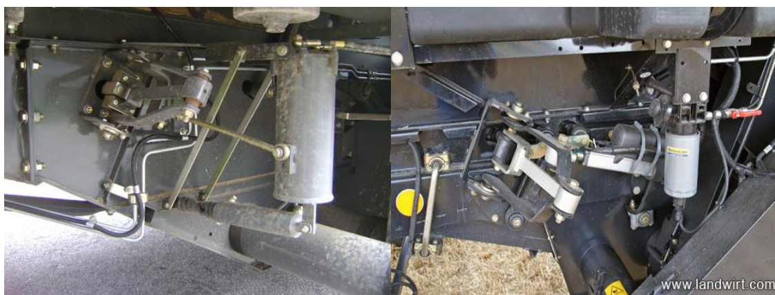
Obr. 28. Vyrovnávání síťové skříně 3-D [LANDWIRT] Obr. 29. Vyrovnávání síťové skříně Smart Sieve [GAILER]
