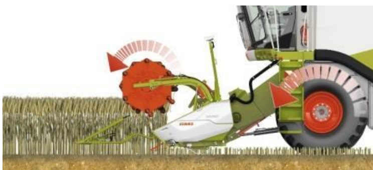
Obr. 10. Synchronizace otáček přiháněče s pojezdovou rychlostí [CLAAS KGAA MBH Lexion 670, 660, 650, 640, 630, 620]
