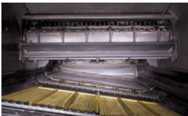
Obr. 24. Příčné vyrovnávání sítové skříně [NOVLAN BROS SALES 2012]
