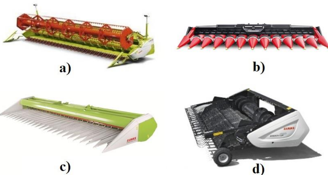
Obr. 7. Sklízecí ústrojí sklízecích mlátiček pro různé plodiny [CLAAS KGAA MBH Vorsatzgeräte][GERINGHOFF][AUTOLINE]
