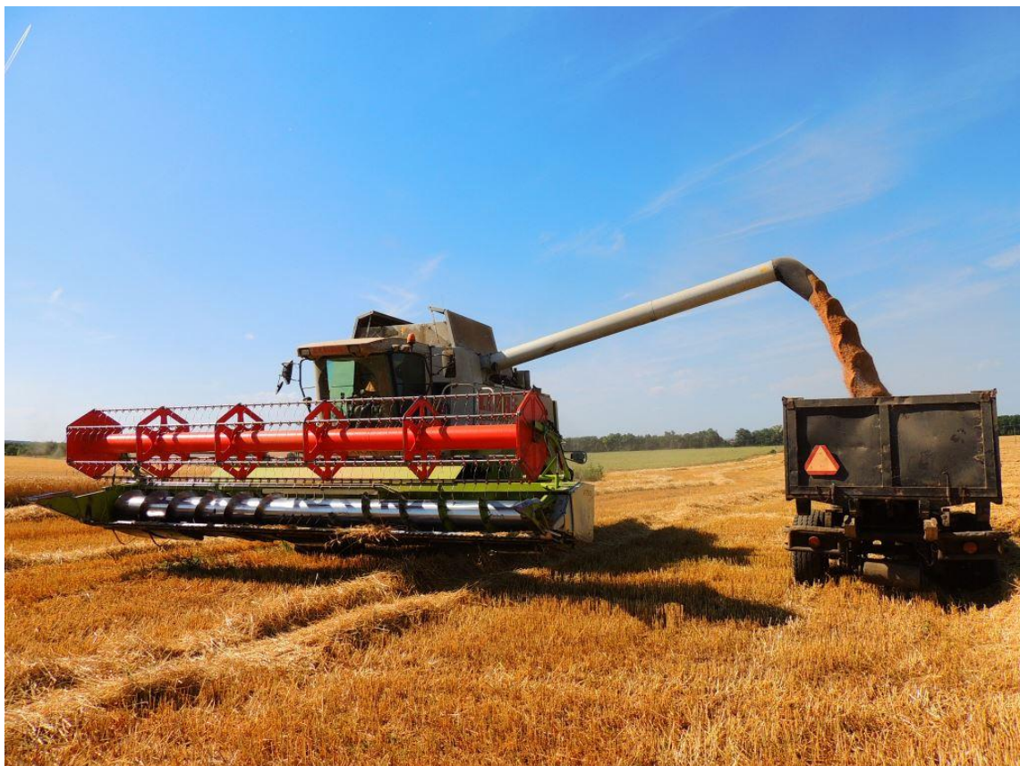
Obr. 1. Sklízecí mlátička při vyprazdňování zásobníku zrna [FOTO-autor]
