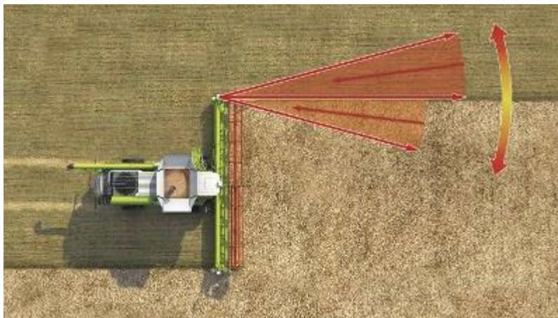
Obr. 31. Navádění sklízecí mlátičky prostřednictvím systému Laser pilot [CLAAS KGA MBH Automatische lenksysteme]
