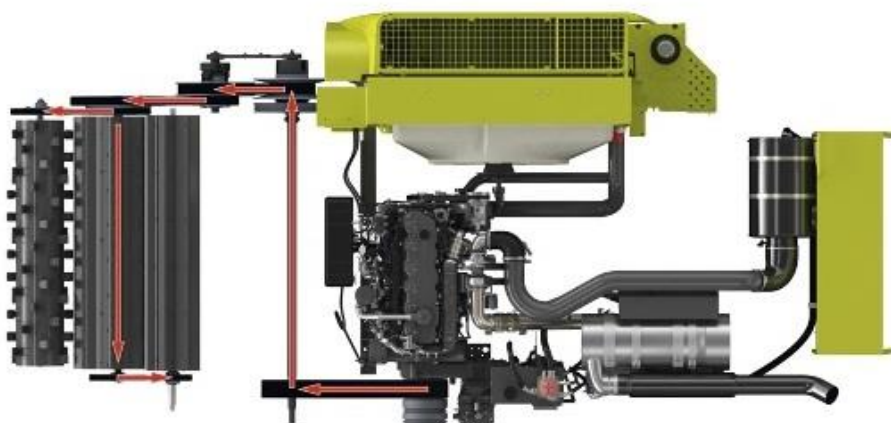
Obr. 13. Mechanický pohon mlátícího ústrojí s hydraulicky ovládaným variátorem [CLAAS KGAA MBH Lexion 670, 660, 650, 640, 630, 620]
