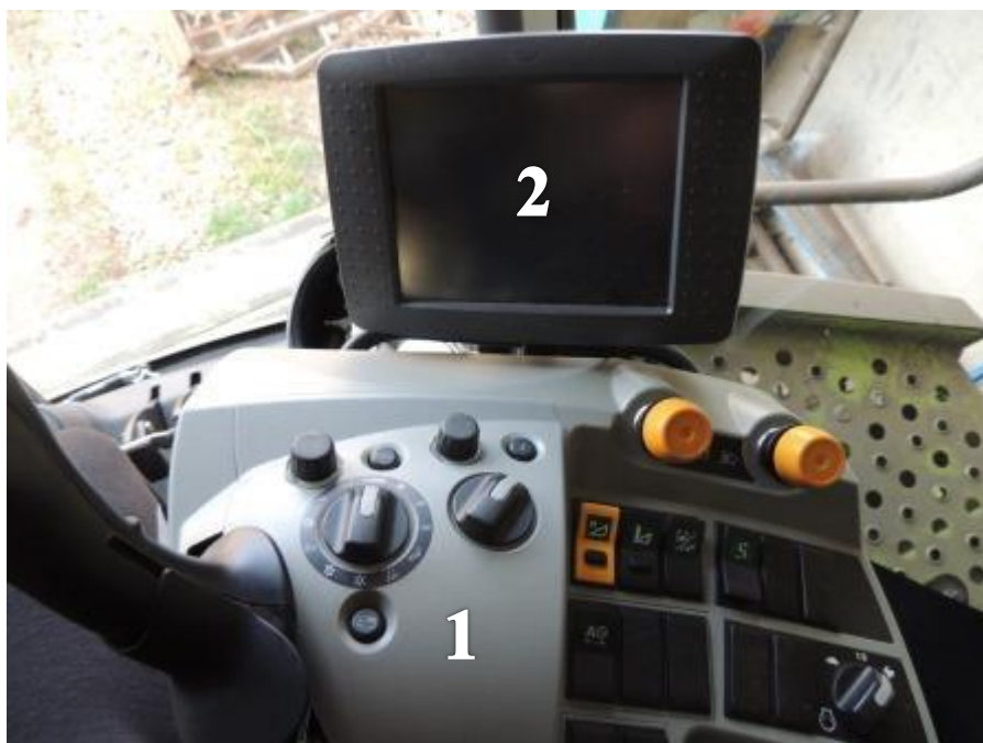
Obr. 33. Elektronický palubní informační systém [FOTO-autor]
