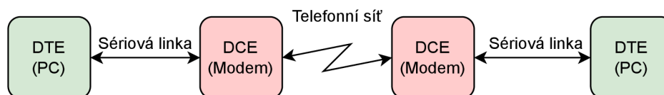
Obrázek 2.1: Propojení dvou PC přes telefonní síť
