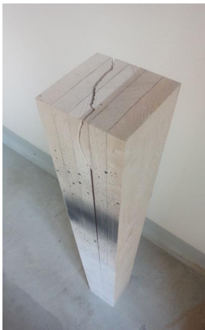
Obr 42– Porušení lepené spáry u hranolu č. 17
