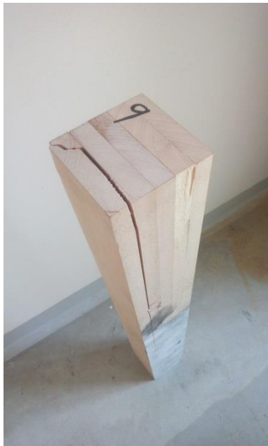
Obr. 41– Porušení lepené spáry u hranolu č. 9
