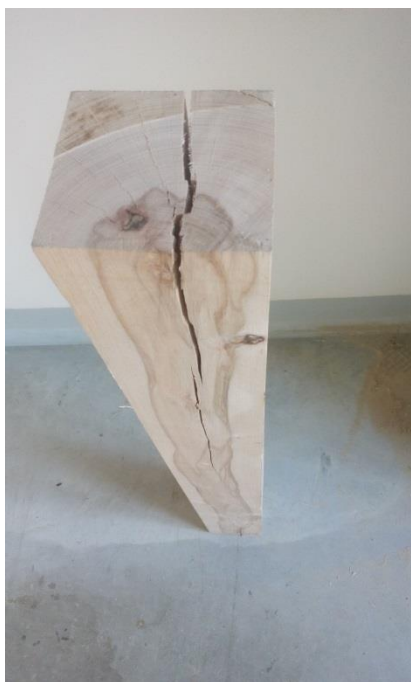
Obr. 45. Porušení masivního hranolu se dřeni
