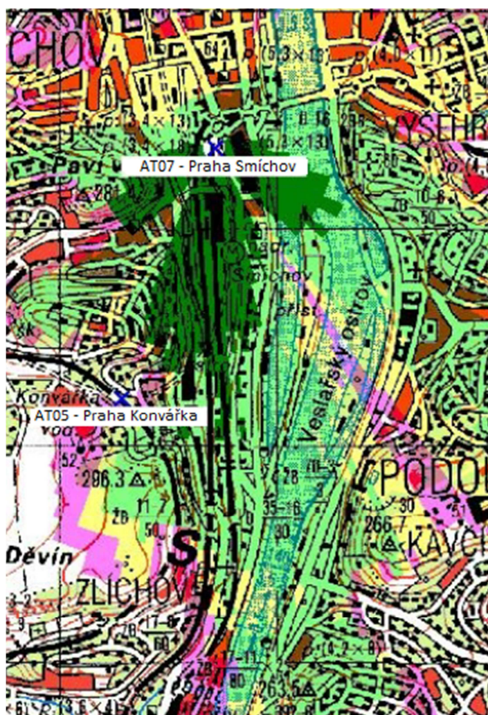
Obrázek č. 25: Simulace pokrytí ve stanici Praha Smíchov
