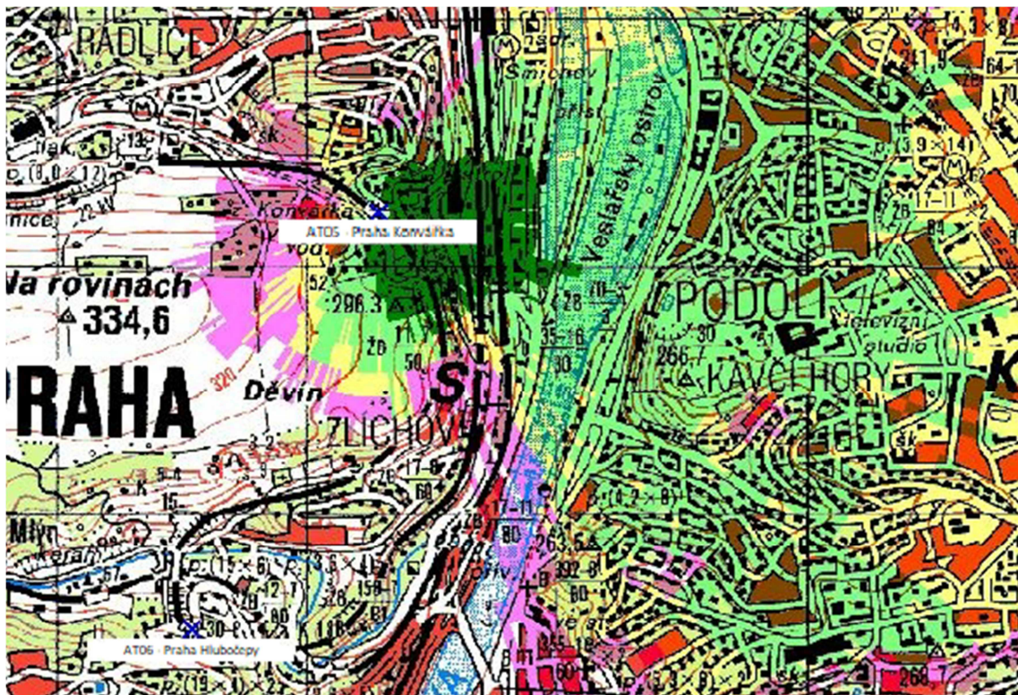
Obrázek č. 23: Simulace pokrytí v lokalitě Praha Konvářka
