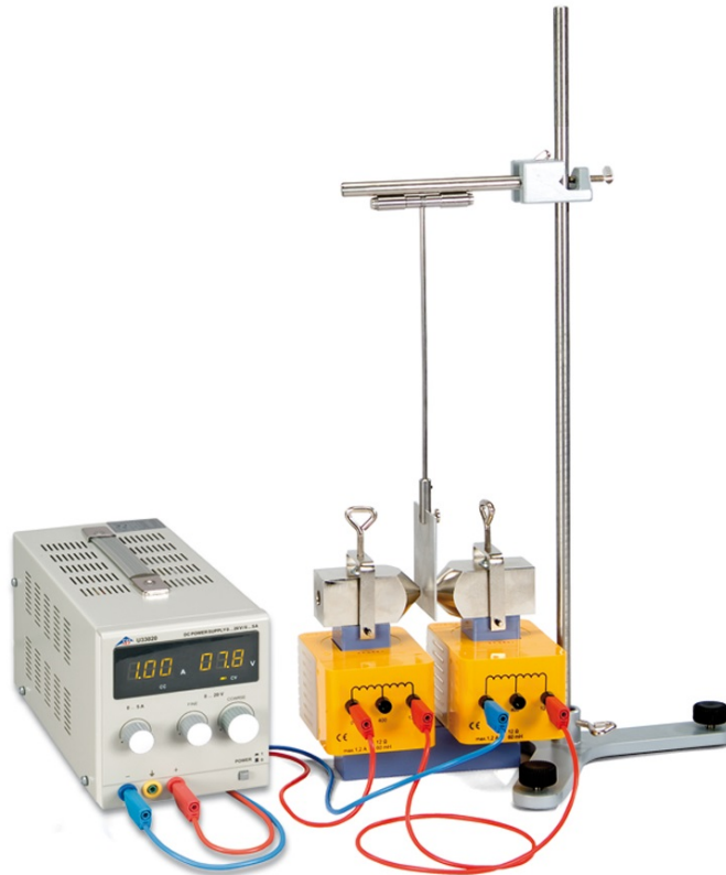
Obrázek 3.2: Experiment s Waltenhofenovým kyvadlem [8]
