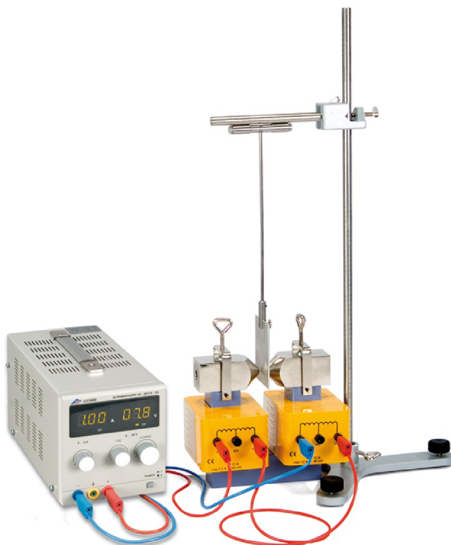
Obrázek 3.2: Experiment s Waltenhofenovým kyvadlem [8]
