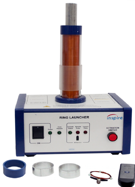
Obrázek 3.3: Experiment s levitujícím prstencem
