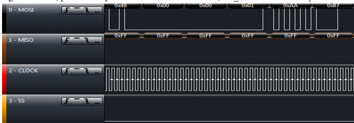
Obr. 23 - Přenos příkazu CMD8 pomocí SPI rozhraní. Výstup z logického analyzátoru
