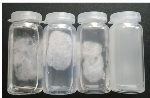
Obrázek 6.8: Vlákenná sraženina bez přídavku NaCl, přídavek 0,045 g NaCl (fyziologický roztok), 0,09 g NaCl a 1,8 g NaCl
