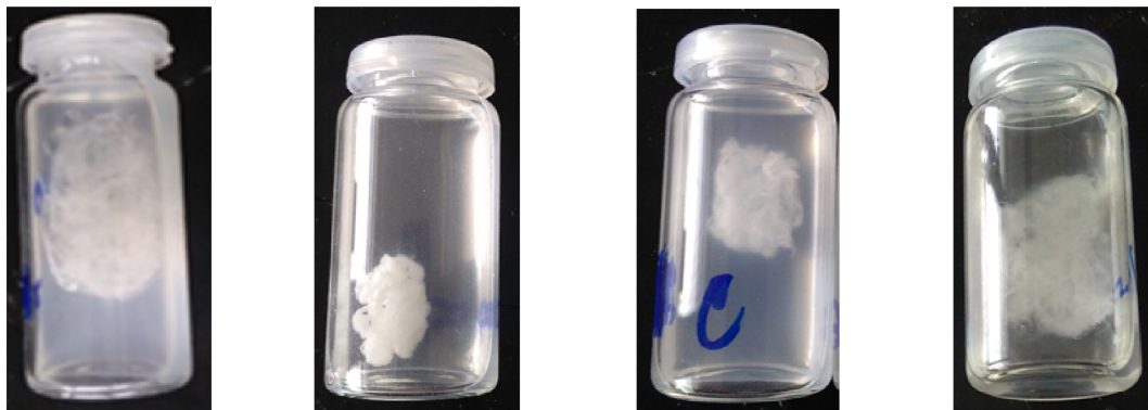
Obrázek 6.2: Vlákenné precipitáty aminojílu s LMW HyA zleva vzorek č. 2, č. 3, č. 4 a č. 5
