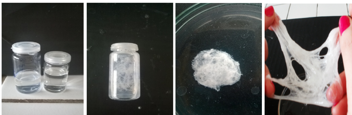
Obrázek 6.1: Vzniklá sraženina aminojílu a MMW HyA – referenční vzorek č. 1
