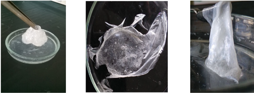
Obrázek 6.10: Zleva: hydrogel Aj-Hya, před vyschnutí, jeho vysušená forma a forma rehydratovaná
