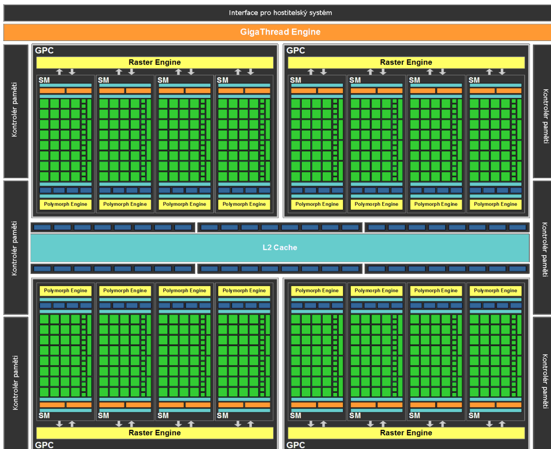
Obrázek 2.13: Blokový diagram technologie CUDA na architektuře Nvidia Fermi, zdroj: Benchmark Reviews
