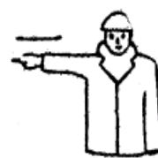
Vpravo od signalisty Pravá paže je vodorovně upažena s dlaní obrácenou dolů a pohybuje se pomalými pohyby vpravo
