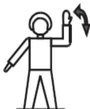
Točte vlevo Pravá paže směřuje dolů, levá dlaní nazad opakuje pohyb vzhůru a vzad z předpažení. Rychlost pohybu naznačuje rychlost otáčení.
