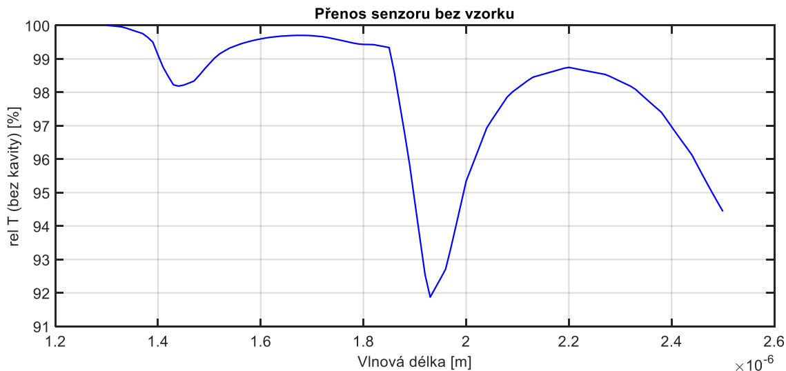
Obrázek 67 – Přenos senzoru bez rozhraní a bez vzorku. Přenos ovlivňuje jen absorpce vody. Parametry modelu: Úhel osvitu: 80^\circ , L = 1 cm, a=52,5 \mu\text{m} , n_{co}=1,457 , n_{cl}=1,440 , R = 0 , t = 0 . Relativní transmise je malá, pro použití kavitní techniky musí být nejméně 99%.
