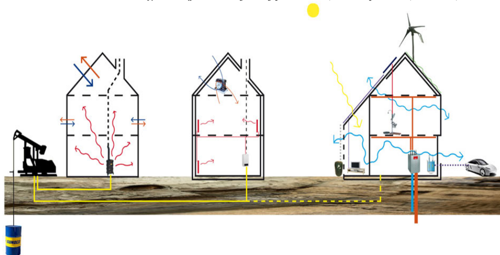
Obrázek 19 - schéma fungování jednotlivých typů budov, zleva pasivní, nulová, aktivní
