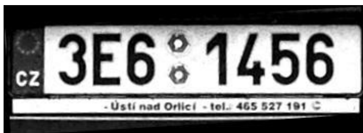
Obr. 7.6 Obraz registrační po korekci natočení
