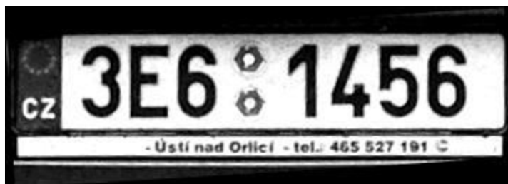
Obr. 7.6 Obraz registrační po korekci natočení
