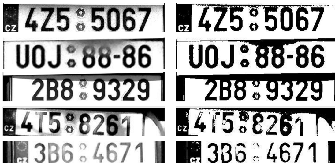
Obr. 7.11 Příklad špatně segmentovaných registračních značek (vpravo) a jejich šedotónové originály (vlevo)
