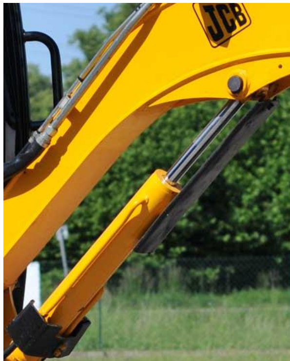
Obr. č. 59 Detail krytu pístní tyče [45]
