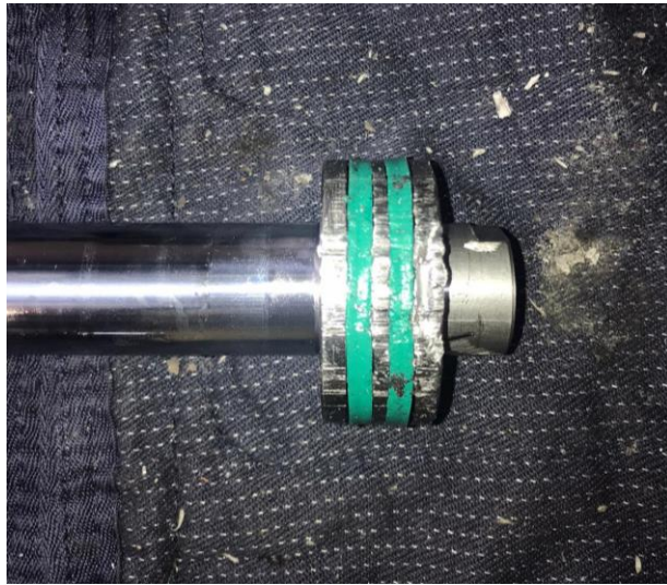
Obr. č. 53 Poškození hlavy pístu [24]
