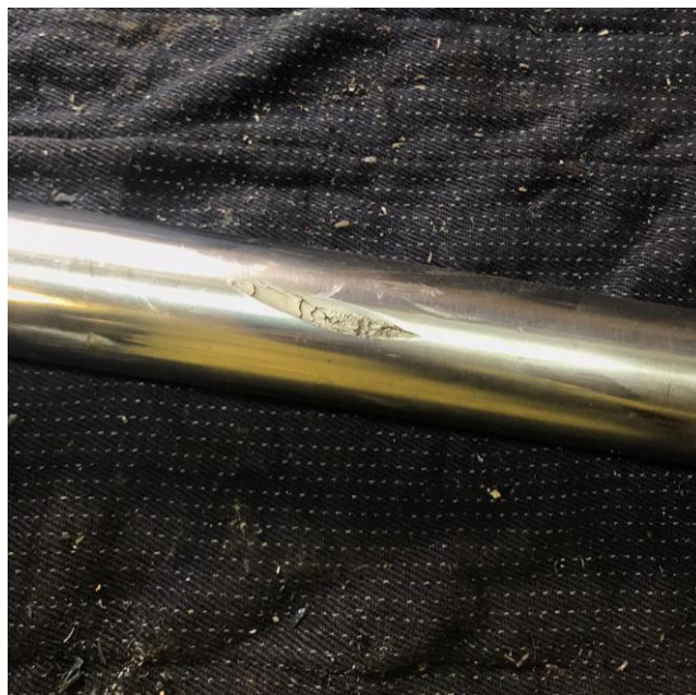
Obr. č. 54 Poškození pístní tyče [24]
