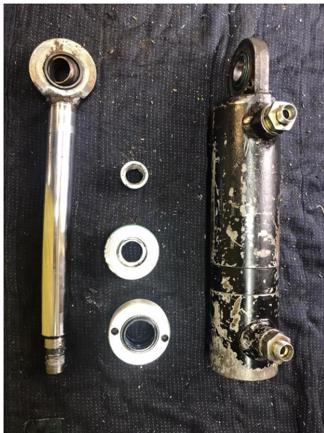
Obr. č. 56 Části hydraulického válce [24]
