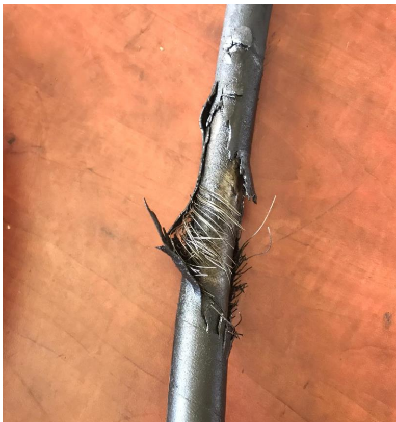
Obr. č. 31 poškozená hydraulická hadice [24]
