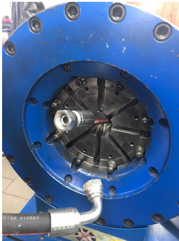
Obr. č. 47 Hadice před i po zalisování [24]
