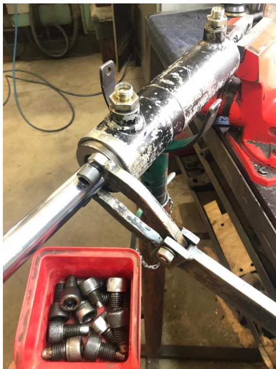
Obr. č. 50 Povolování víka [24]
