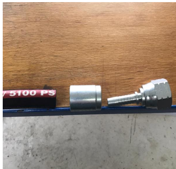
Obr. č. 44 Skládání koncových částí hadice [24]
