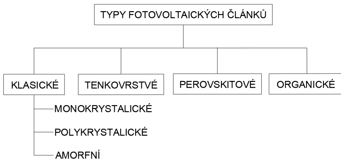
Obr. 1: Dělení fotovoltaických článků (Brož a Šourek, 2003, upravil Douđa)
