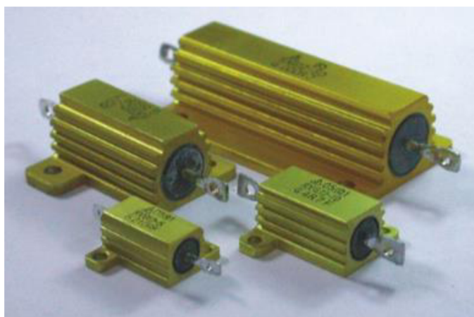
Obrázek 3.9: Drátový rezistor v kovovém pouzdře [38].
