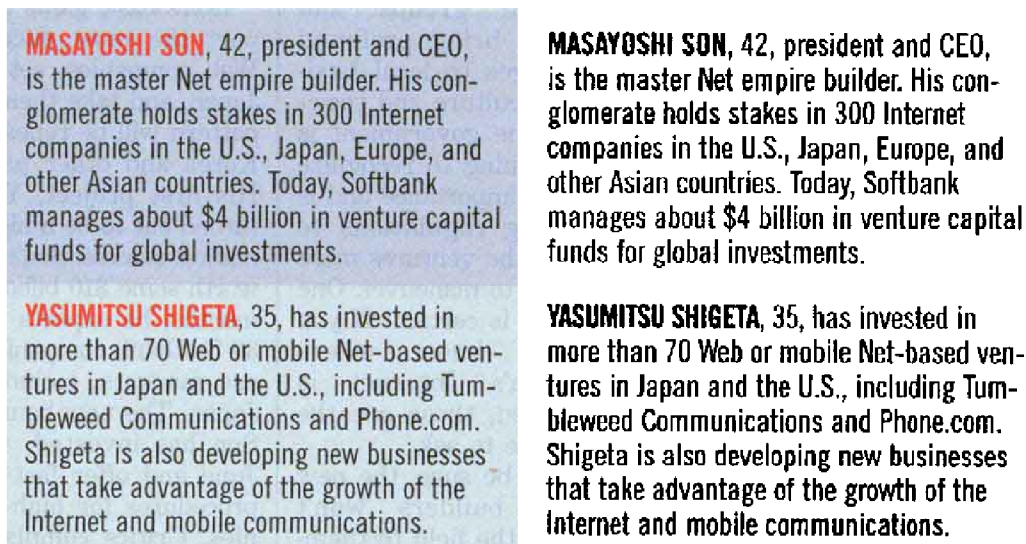
Obr. 2.1: Na obrázku sa nachádza dokument, ktorý prešiel binarizáciou v OCR softvéri. Vľavo je dokument pred, vpravo po binarizácii. Obrázok bol prevzatý z literatúry [22].
