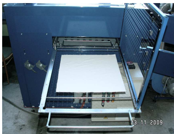
Obrázek 27: Rám pro vkládání a vyndávání měřených vzorků ze sušárny
