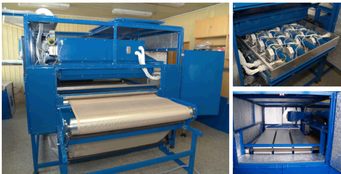
Obrázek 73: Mikrovlnná sušárna plošných textilií ImpactWave (vpravo nahoře – osazení mikrovlnné elektroniky, vpravo dole – impaktní část) [19]
