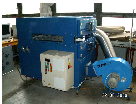
Obrázek 25: Experimentální impaktní sušárna – skutečnost
