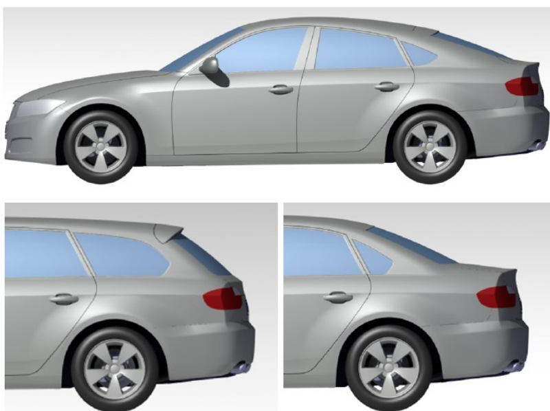
Obr 18: Jednotlivé části variabilní geometrie vozidla DrivAer [26]
