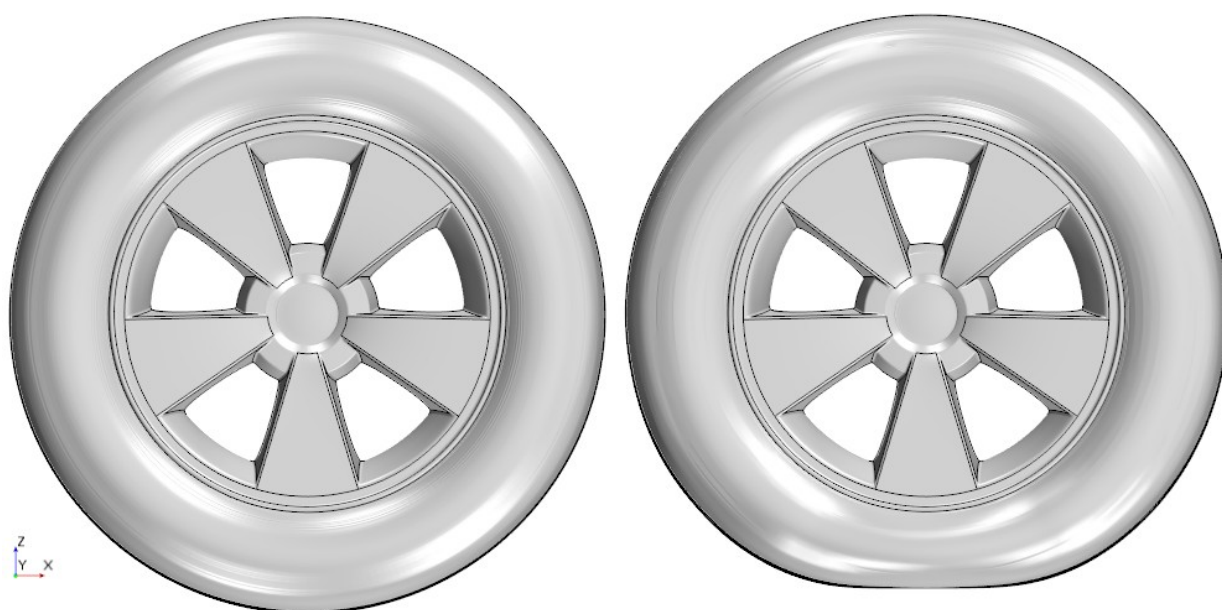
Obr 25: Porovnání geometrie nezatíženého a zatíženého kola (pohled z boku)
