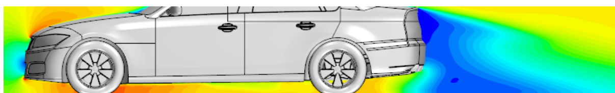
Obr 57: Rychlost - detail proudu pod vozidlem ( y=0 mm); V007 - nahoře, V010 - dole
