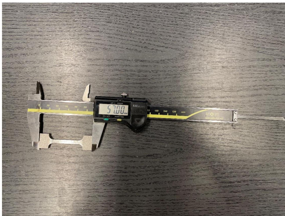
Obr. 50 Zkušební vzorek materiálu Inconel 625 pro statickou zkoušku za tepla
