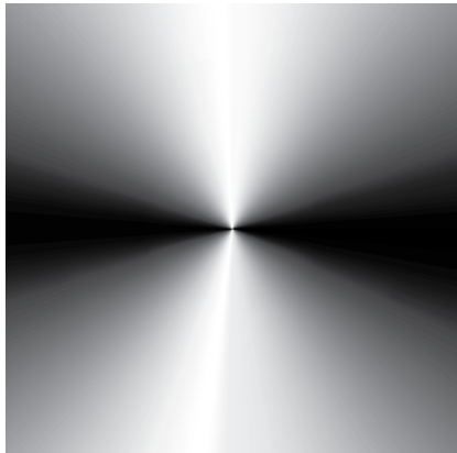
Obrázek 1.7: Intenzitní obraz SFD umístěné mezi dvěma lineárními polarizátory [15].
