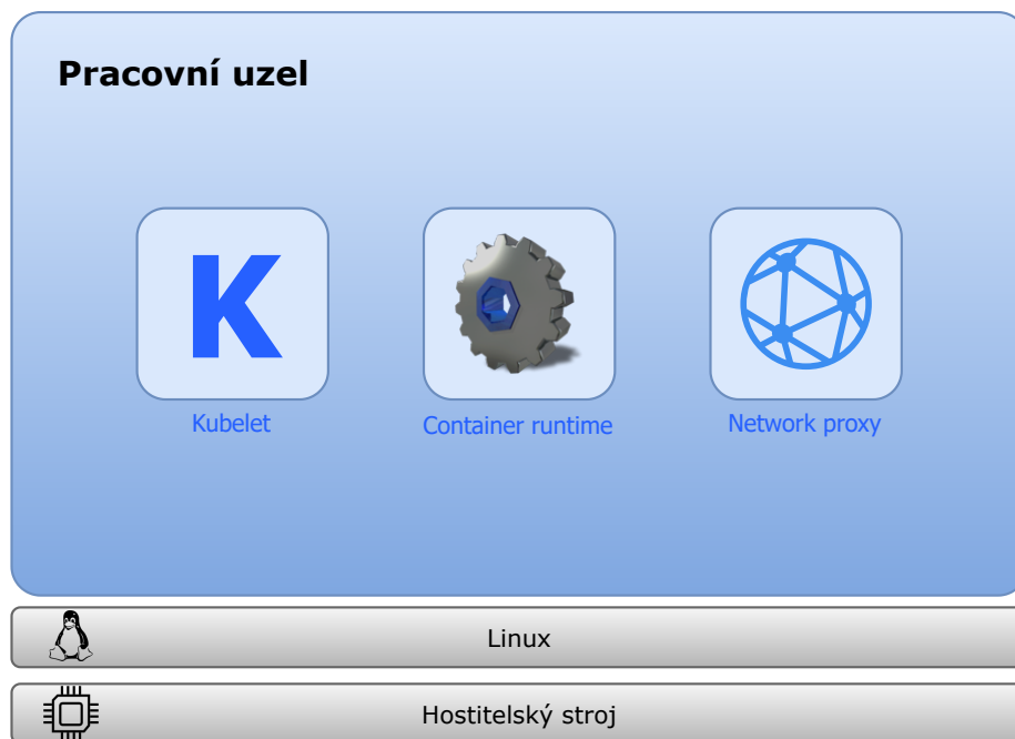
Obrázek 2.5: Pracovní uzel . Na obrázku je vidět architektura pracovního uzlu a jeho jednotlivé části.
