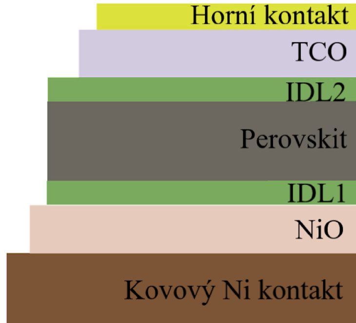
Obrázek 3.2 Blokový diagram inverzní struktury perovskitového solárního článku. [41]
