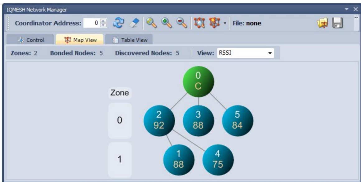
Obrázek 18 - Ukázka topologie sítě v IQMESH Network Manageru [autor]
