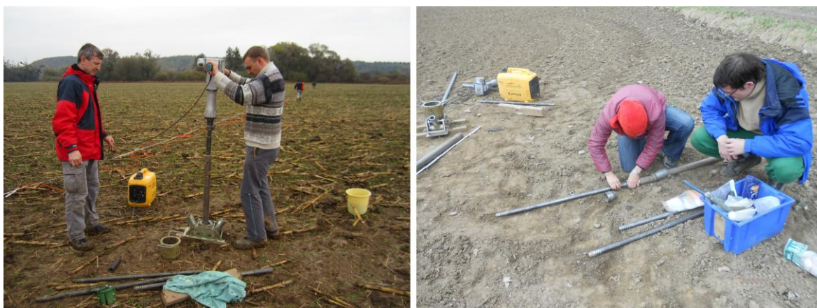
Obrázek 17: Terénní odběr vrtných jader pomocí perkusní vrtné soupravy na lokalitách Doubravice a PP Kurfürstovo rameno. (Foto L. Bartošová a I. Medek)
