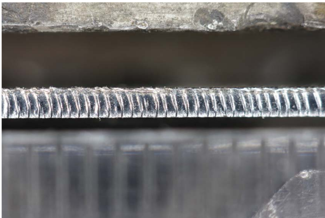
Makro řezné hrany měřeného vzorku z oceli DC 01 o tloušťce 1 mm
