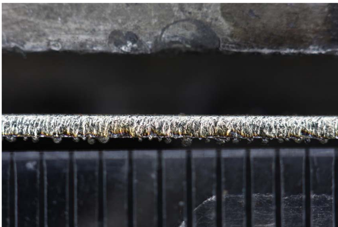
Makro řezné hrany měřeného vzorku z nerez oceli o tloušťce 1 mm
