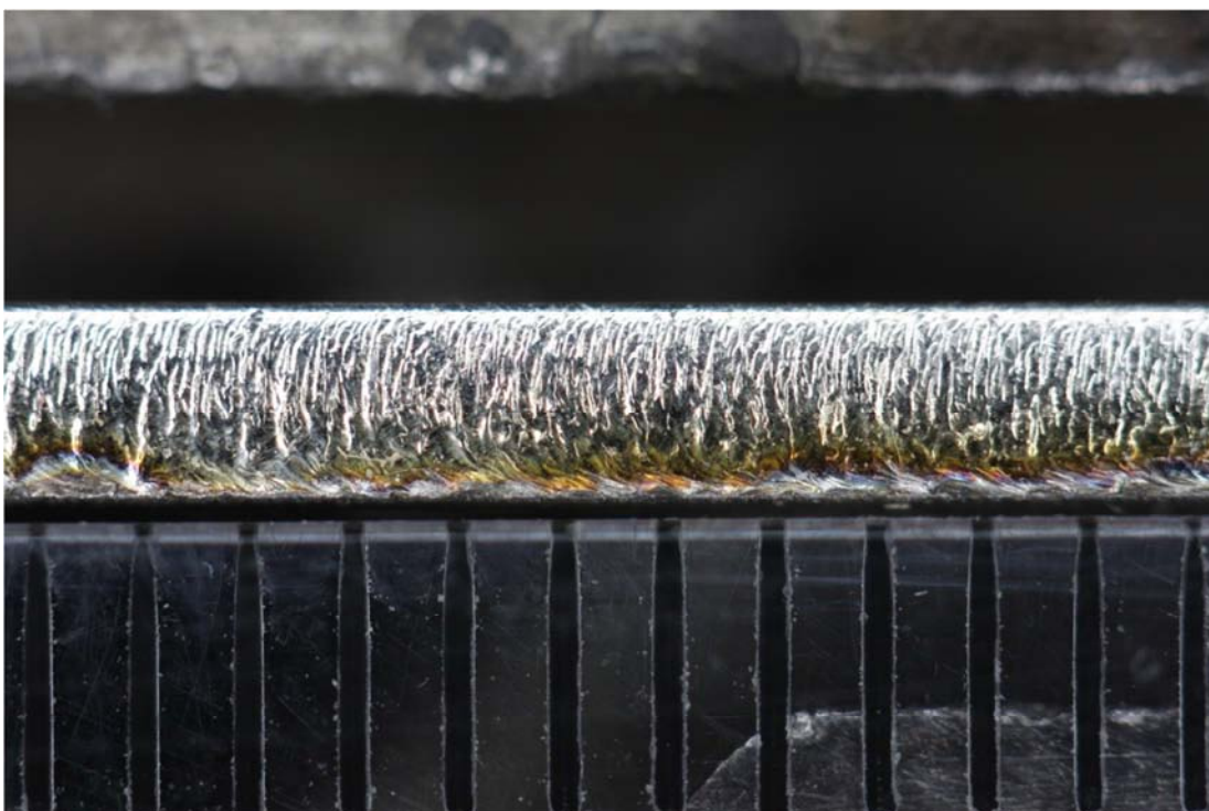
Makro řezné hrany měřeného vzorku z nerez oceli o tloušťce 2 mm
