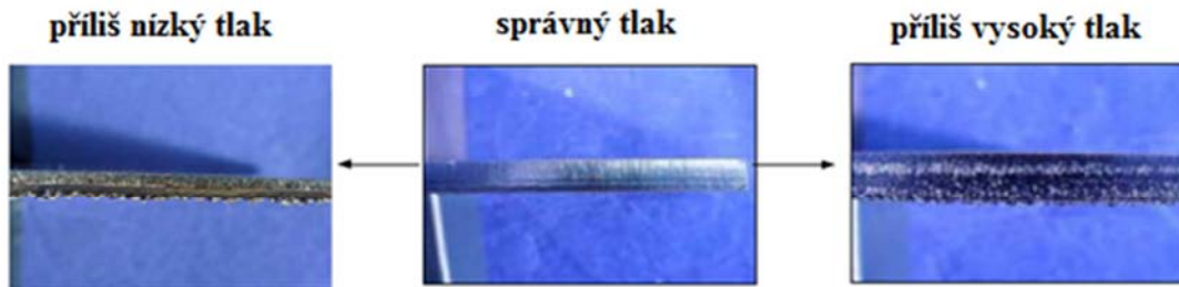
Obr. č. 26 Řez prováděný s různým nastavením tlaku plynu [1]
