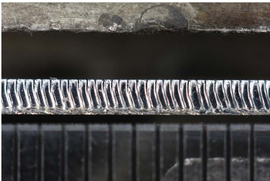
Makro řezné hrany měřeného vzorku z oceli DC 01 o tloušťce 1,5 mm
