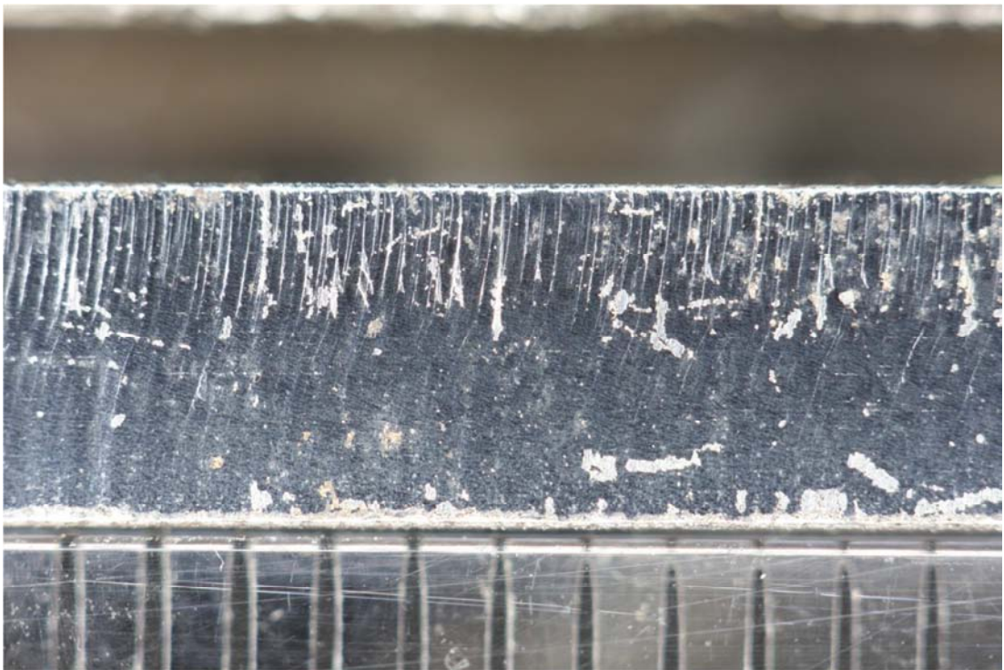
Makro řezné hrany pro ilustraci z oceli S235 JRG o tloušťce 4 mm, při použití CO 2 jako řezného plynu
