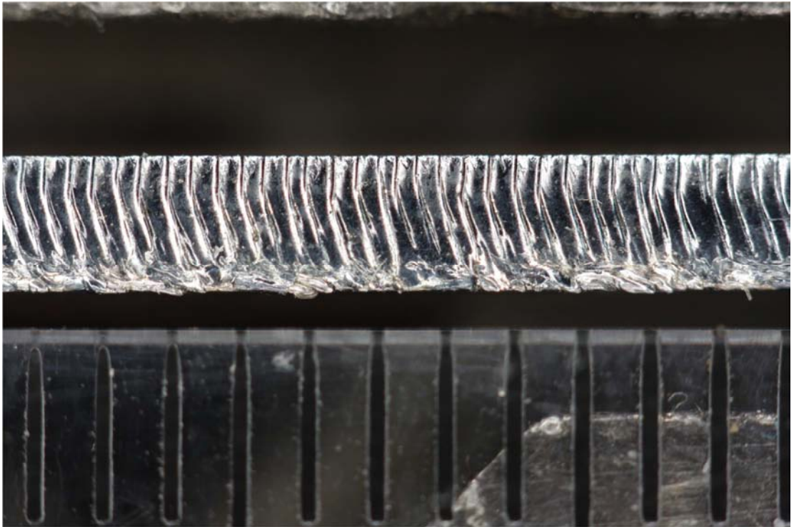
Makro řezné hrany měřeného vzorku z oceli DC 01 o tloušťce 2 mm
