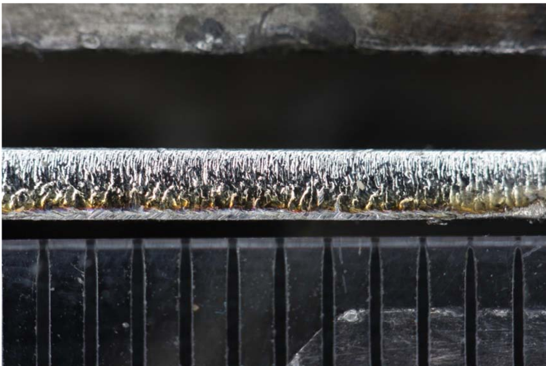
Makro řezné hrany měřeného vzorku z nerez oceli o tloušťce 1,5 mm
