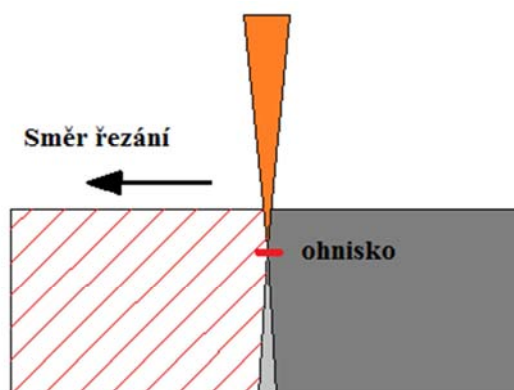
Obr. č. 20 Ohnisko - oxidační řezání [26]
