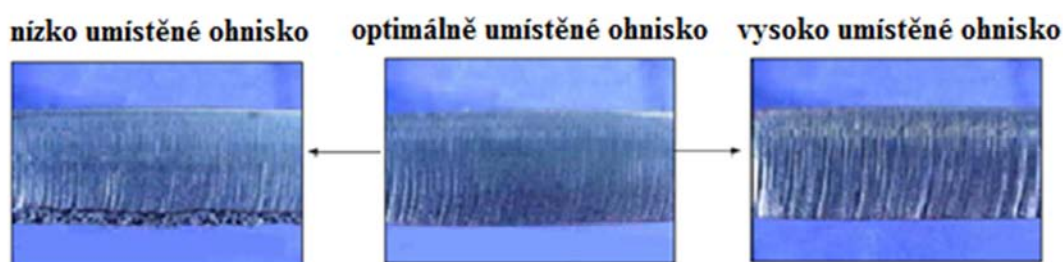
Obr. č. 24 Řezy s různými polohami ohniska [1]
