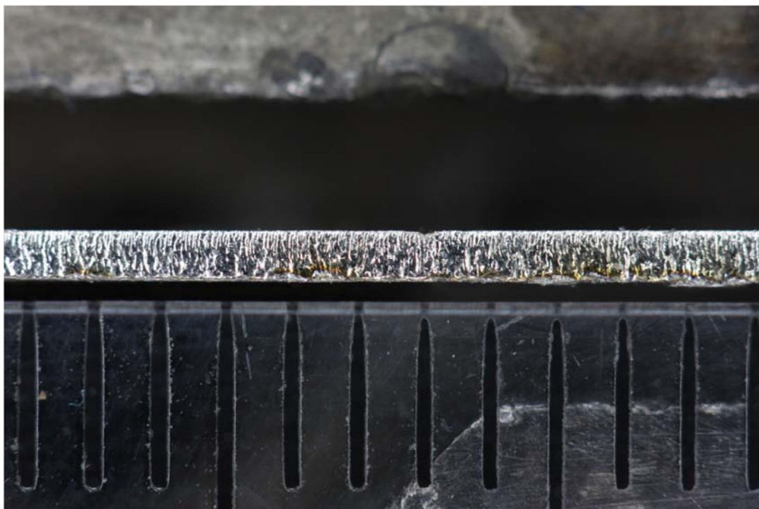
Makro řezné hrany měřeného vzorku z nerez oceli o tloušťce 0,8 mm
