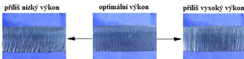
Obr. č. 22 Řezy při různých řezných výkonech laserového paprsku [1]
