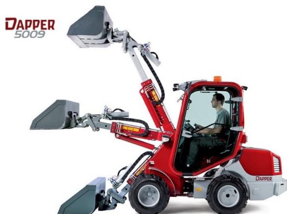
Obr. 5 Demonstrace pohybu pracovního ústrojí [2].
