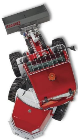
Obr. 2 Ukázka natočení kloubového podvozku stroje DAPPER 5000 [2].
