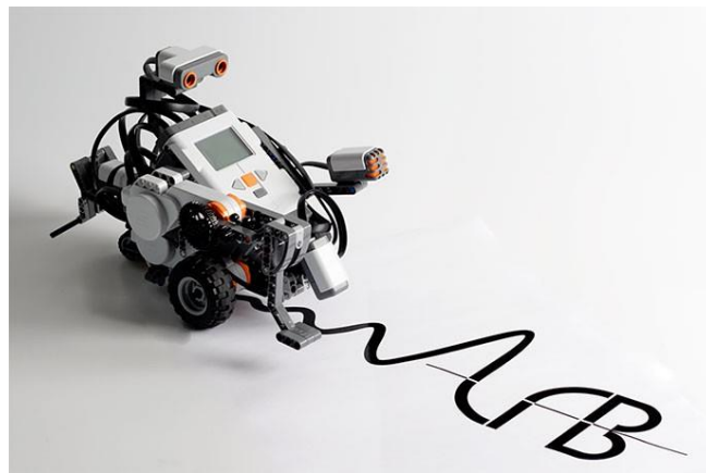
Obrázek 24 Robot sleduje černou čáru na papíře [31]
