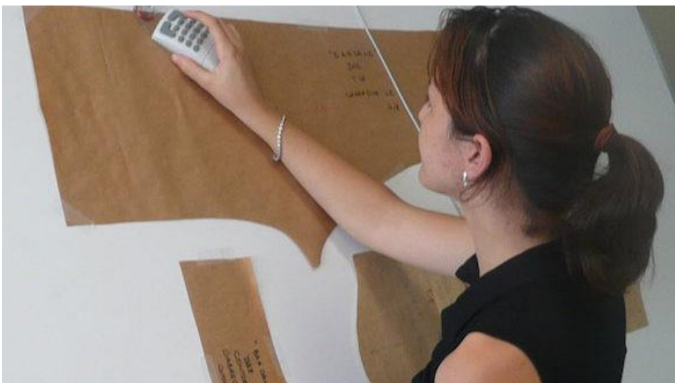
Obr. 5 Získávání digitalizovaného stříhu pomocí digitizeru [3]
