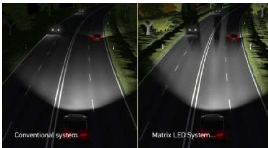
Obr. 1.5 Porovnání standardních světlometů a maticových světlometů bránících oslnění řidičů [4]
