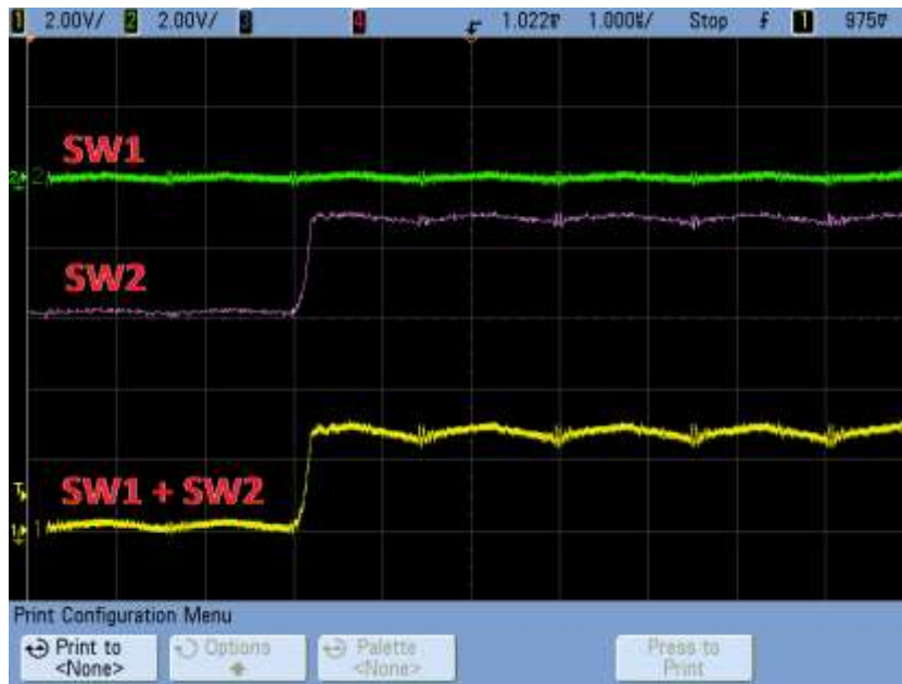
Obr. 4.6 Průběh rozepnutí spínače SW2
