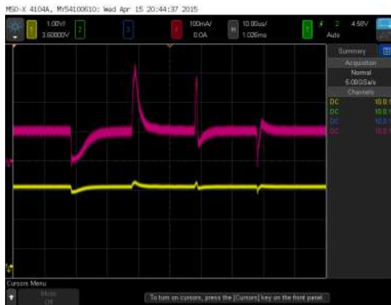
Obr. 5.17 Záznam přechodů, zleva OFF; ON; ON + OFF; ON + (OFF-1)
