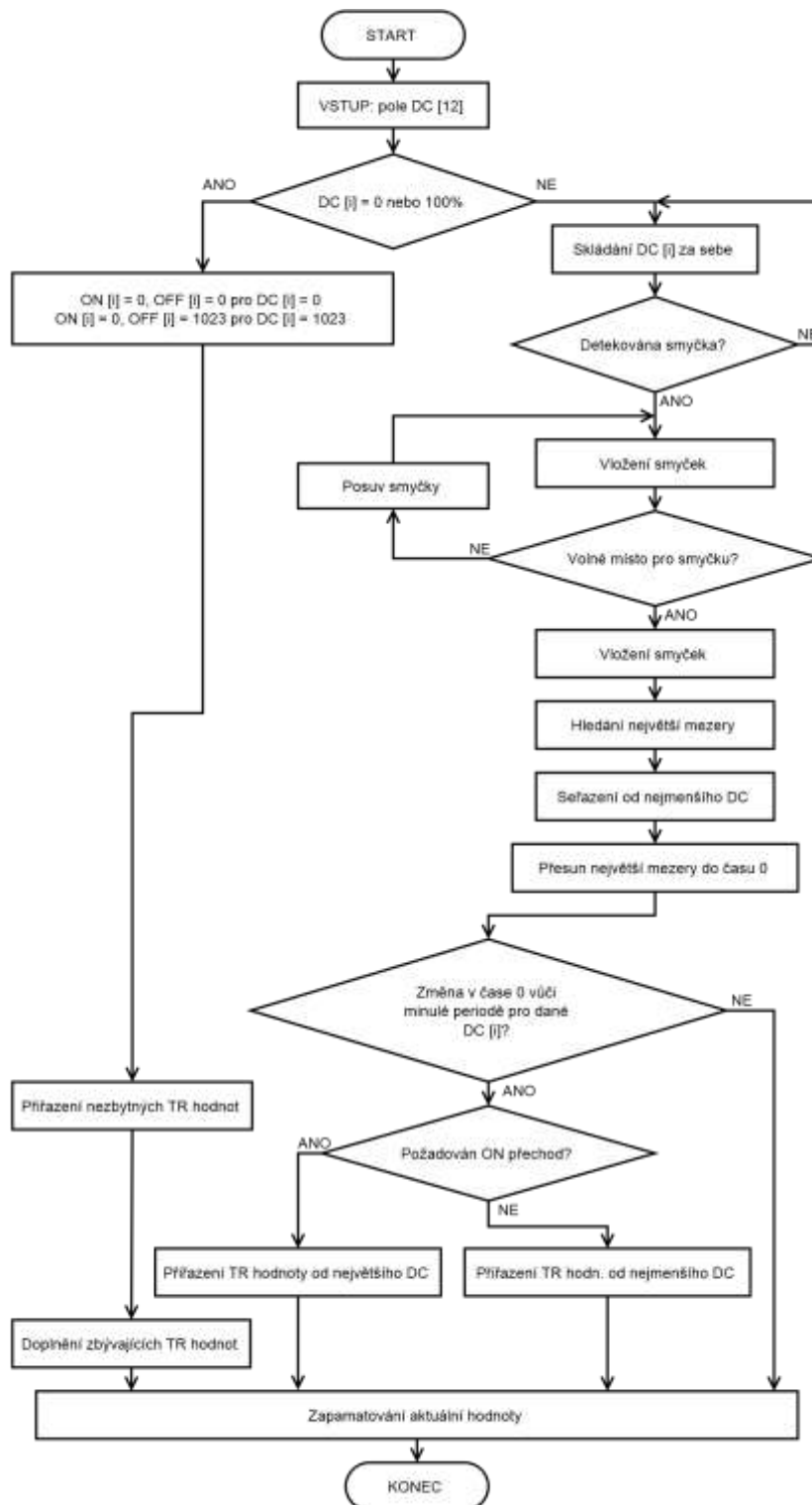
Obr. 5.16 Vývojový diagram pokročilého algoritmu s překryváním
