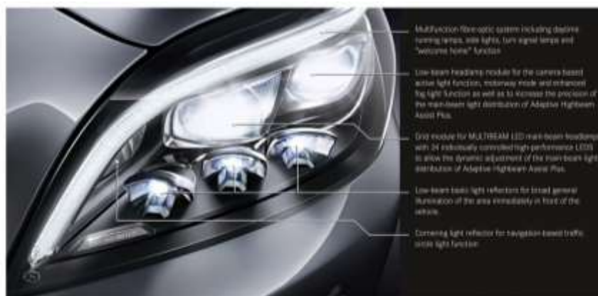
Obr. 1.10 Popis světlometu Mercedes-Benz Multibeam Headlamp [9]
