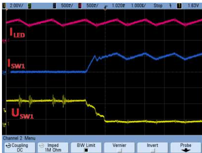
Obr. 4.7 Průběh proudu spínačem a LED řetězcem při sepnutí spínače SW1
