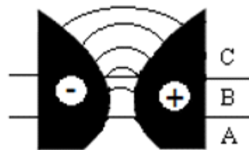
Obr. 2: Fáza kĺzavého oblúkového výboja: A – oblasť elektrického prierezu, B – oblasť rovnovážnej plazmy, C – oblasť nerovnovážnej plazmy [12].
