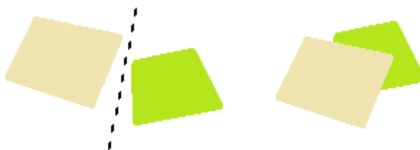
Obrázek 3.5: Vlevo existuje dělicí přímka (bez kolize), vpravo neexistuje (kolize)
