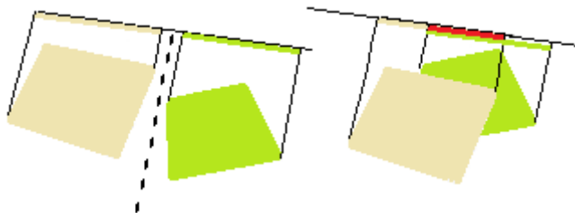
Obrázek 3.6: Vlevo průměty bez průniku (bez kolize), vpravo se průměty protínají (kolize)
