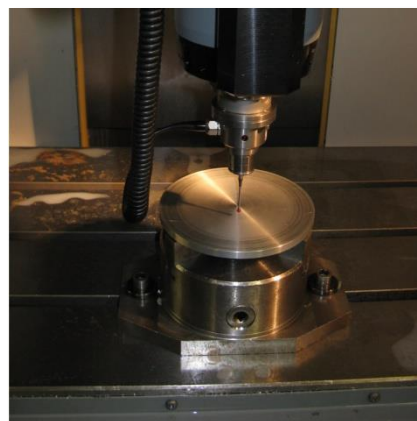
Obr. 5.11 Nadefinování nulového bodu obrobku pomocí dotykové sondy.
