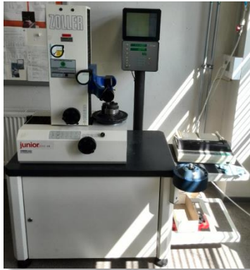
Obr. 5.2 Měření délkových a rádiusových korekcí na měřicím přístroji ZOLLER.
