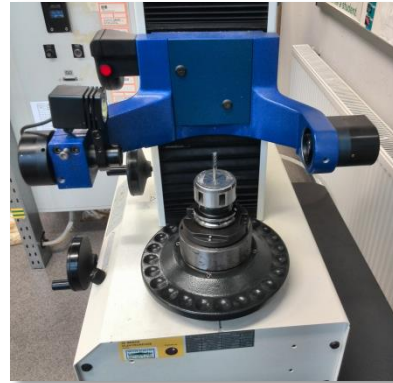
Obr. 5.2 Měření délkových a rádiusových korekcí na měřicím přístroji ZOLLER.
