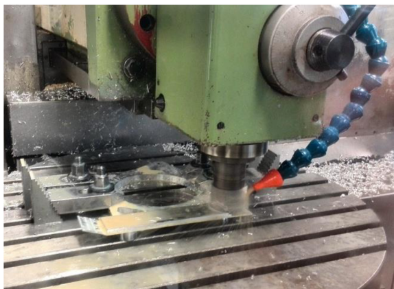
Obr. 5.8 Odstranění zbývajícího materiálu.
