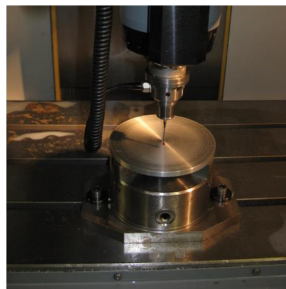
Obr. 5.11 Nadefinování nulového bodu obrobku pomocí dotykové sondy.
