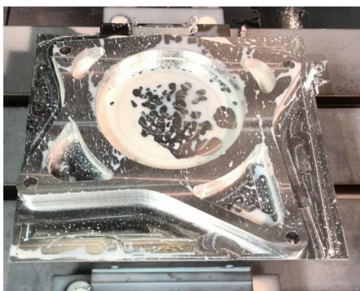
Obr. 5.6 Tvar obrobku po vrtání vrtákem o \varnothing 10 mm.
