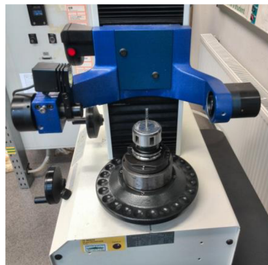
Obr. 5.2 Měření délkových a rádiusových korekcí na měřicím přístroji ZOLLER.
