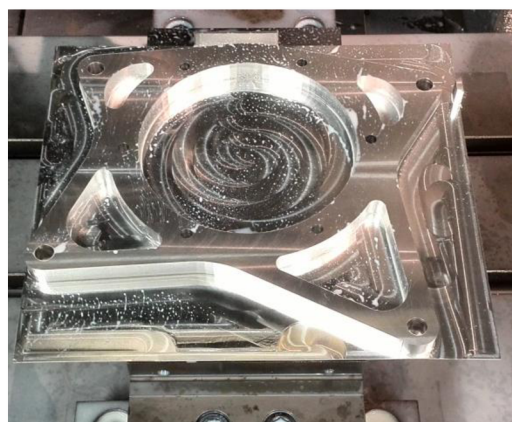
Obr. 5.7 Tvar obrobku po vrtání vrtákem o \varnothing 6,3 mm.
