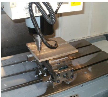
Obr. 5.3 Definice nulového bodu obrobku pomocí dotykové sondy Heidenhain TS 220.
