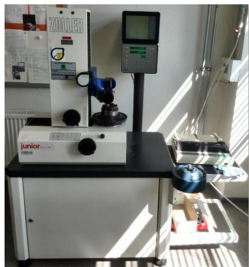
Obr. 5.2 Měření délkových a rádiusových korekcí na měřicím přístroji ZOLLER.
