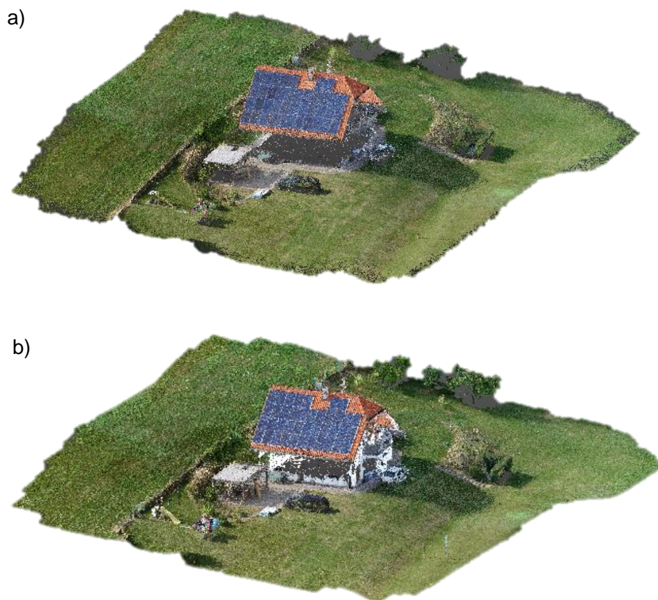
Obr. 8 Zobrazení point cloudu programem Trimble Real Works Viewer 10.2 a) prvotní bodové mračno, b) dohuštěné bodové mračno
