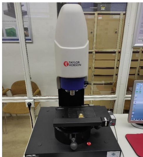
Obrázek 36 Bezdotykový 3D profilometr Taylor Hobson Talysurf CCI Lite.
