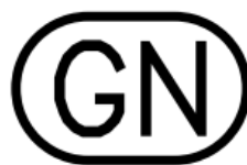
Obrázek 21 Označení modifikátoru minimální opsané kružnice na výkrese [22].
