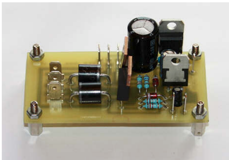
Obr. 10.3 Fotografie osazené desky ochranného napájecího obvodu
