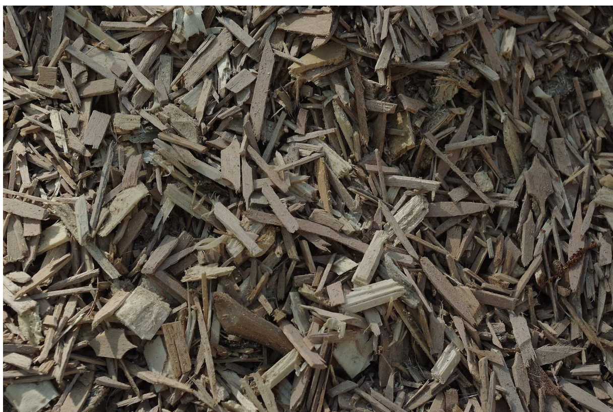
Obr. 4. štepka buková – průmyslový odpad z výroby dřívěk pro zmrzlinu
