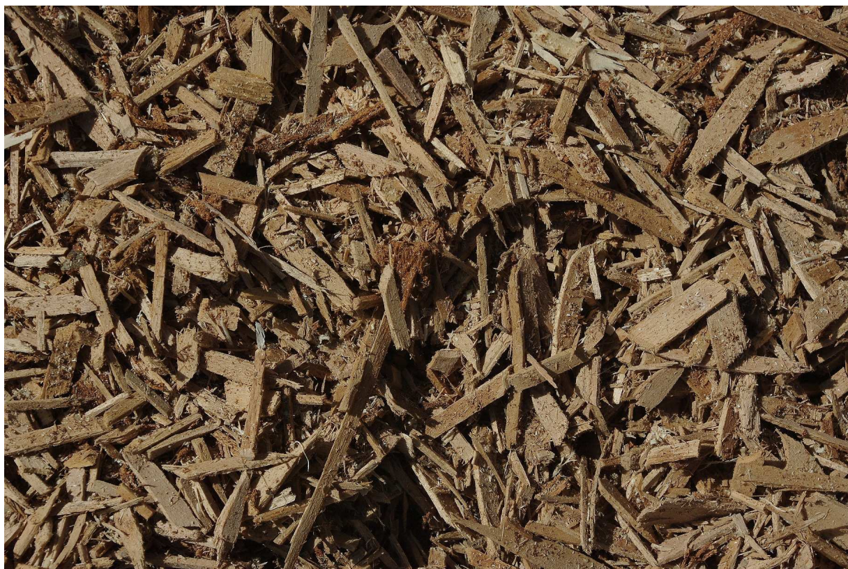
Obr. 3.. pilinoštepka odpad z pilnice
