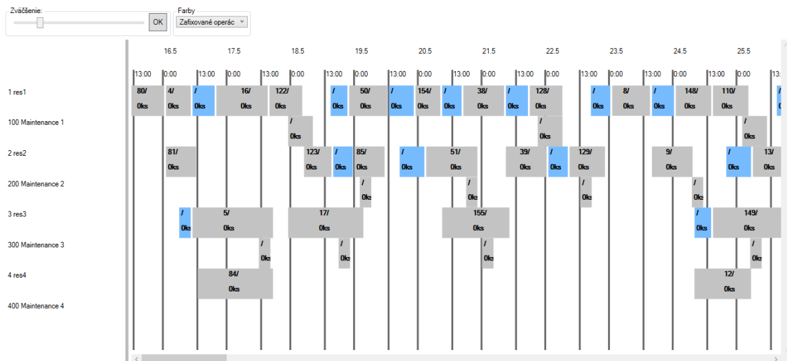
Obr. 4.2: Vizualizácia rozvrhu v informačnom systéme ISIT ganttovým diagramom. Modro znázornené operácie značia rekonfigurácie. Zdroje s pomenovaním maintenance zobrazujú, kedy je vykonávaná údržba.
