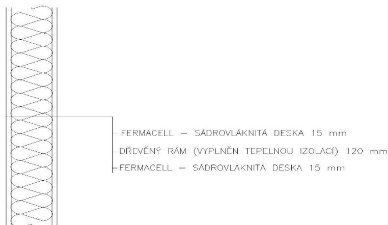
Obr. 6 Skladba vnitřní nosné stěny
