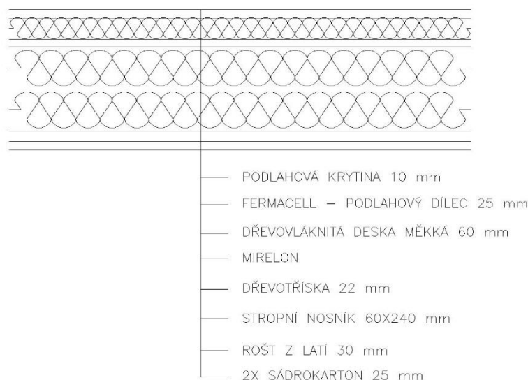
Obr. 7 Skladba stropu v 1. NP
