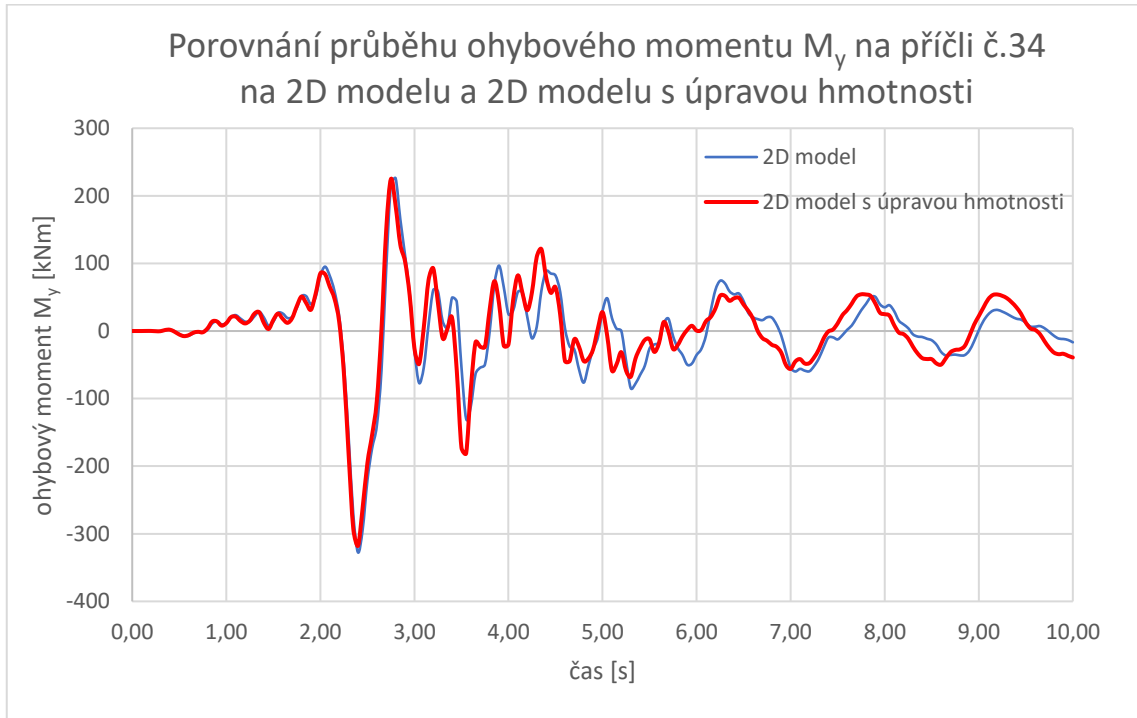
Graf 11.7 - Porovnání průběhu ohybového momentu M_y na příčli č.34 na 2D modelu a 2D modelu s úpravou hmotnosti
