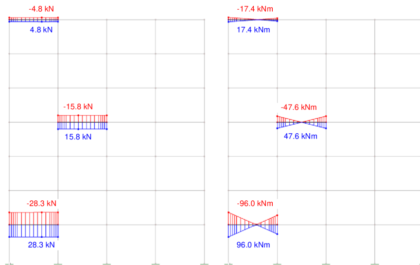
Obr. 7.8 - Posouvající síly (vlevo) a ohybové momenty (vpravo) na příčlích (spektrum typu 2)
