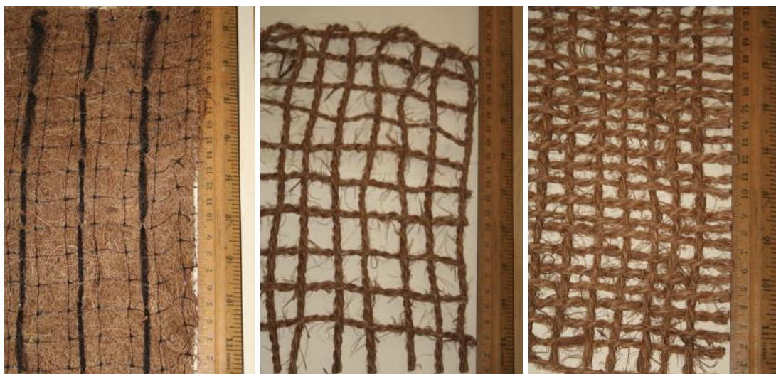
Obrázek 12a, b, c. Typy kokosových geotextilií. Zleva: netkaná rohož 270 g/m 2 , síť 470 g/m 2 a síť 710 g/m 2 (Sutherland et Ziegler 2007).
