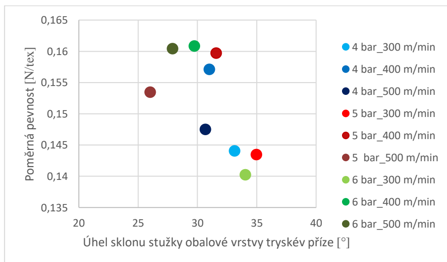
Příloha č. 7: Závislost poměrné pevnosti na úhlu sklonu stužky obalové vrstvy tryskové příze
