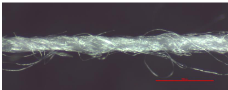
Obr. 18: Podélný pohled na tryskovou přízi
