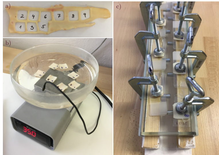
Obrázek 6.3: a) Rozříznutá část aorty s vyseknutými čtvercovými vzorky, b) lázeň z fyziologického roztoku, c) přípravek se stlačenými vzorky s různou mírou deformace.
