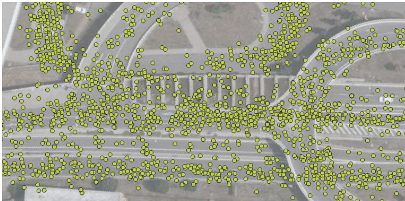
Obrázek 3.11 Distribuce bodů ze sledování vozidel v místě mimoúrovňového křížení komunikací
